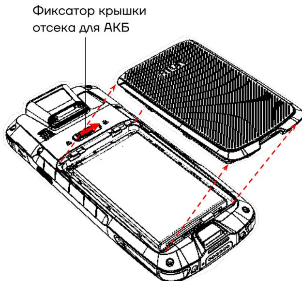
Рисунок 5. Отделение крышки отсека для АКБ от корпуса
